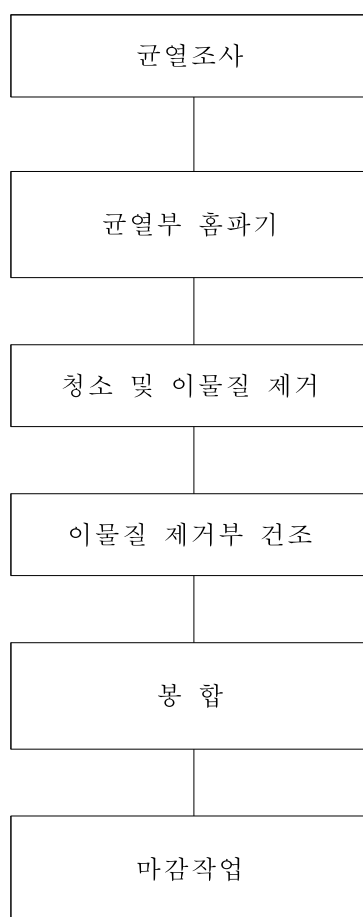
<그림 4.2.14> 교면포장 아스팔트 균열보수
